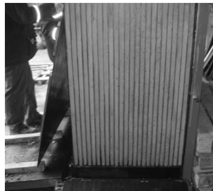
8. ábra 25 db mezőelem a sablonban, szétbontás előtt
