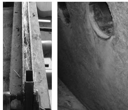
4. ábra A 130 kg/m 3 műanyagszállal, majd habarccsal megtöltött sablon és a kiszaluzott próbalap
