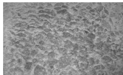
9. ábra Polírozással láthatóvá tett kőzetszemek
