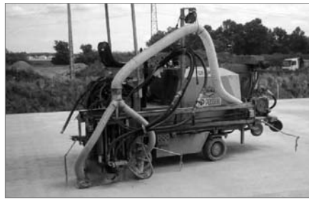
9. ábra Hézagvágó gép vágóiszap felszívó berendezéssel
