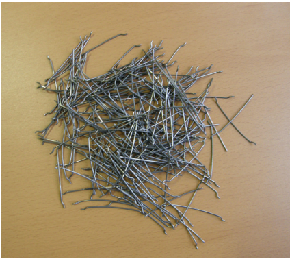
Acélszál statikai erősítésre (forrás: Betonmix Kft.)
