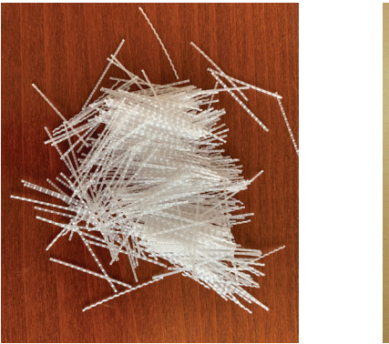
Polipropilén műanyagszál statikai erősítésre (forrás: Betonmix Kft.)
