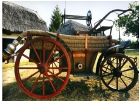
2. számú kép: Süllyesztett medencéjű kocsifecskendő, 1900 (Bérczi et al., 2016a, 69.)
