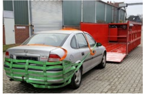
6. számú kép: Személygépjármű bevontatása a RED BOXX konténer beépített csörlőjével (URL9)
