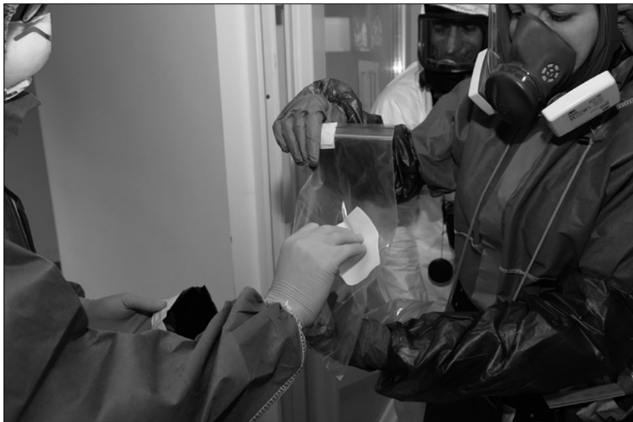
10. számú ábra: Begyűjtött radioaktív anyag tasakjáról vett dörzsminta. Forrás: A szerzők saját szerkesztése
