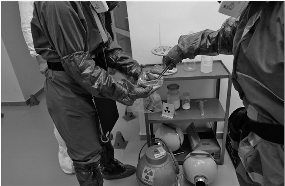
9. számú ábra: Radioaktív anyag begyűjtése két személy közreműködésével (dupla csomagolás, bűnjelcímkézés, gondos lezárás). Forrás: A szerzők saját szerkesztése
