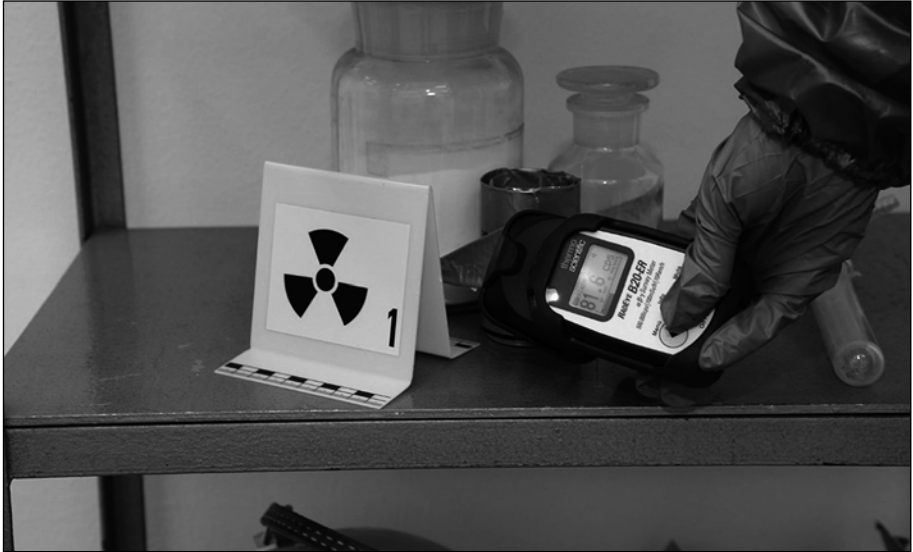
8. számú ábra: Radioaktív anyag (radiológiai bűnjel) jelölése bűnjeljelölő számozott táblával és fényképezése a mérőműszerrel. Forrás: A szerzők saját szerkesztése
