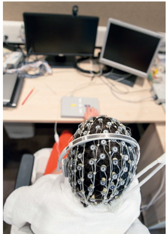
Az agyi elektromos válaszok elvezetésére rugalmas hálóban elhelyezett 128 elektróda szolgál
