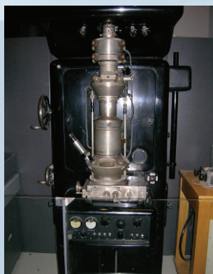
Ernst Ruska 1933-ban készített elektronmikroszkópja (Deutsches Museum, München)
