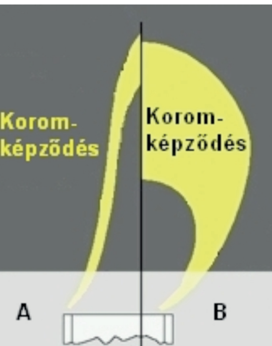
5. ábra. Koromképződés zónája etilén-propilén diffúziós lángjában földi gravitációs (A) és mikrogravitációs (B) térben.
