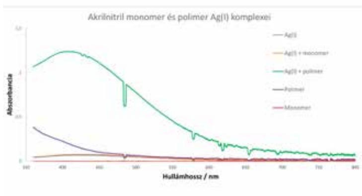
5. ábra: Az Ag(I) ionok fényelnyelésének megváltozása a polimerrel való kölcsönhatás miatt
