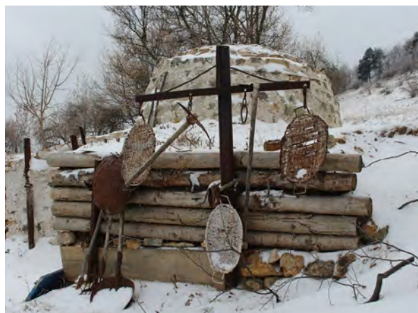
Mész-kemence és a mészégetés eszközei: csákány, szívlapát, vaskosár
