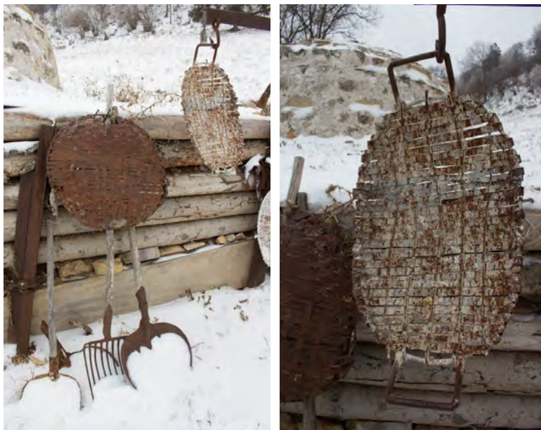
A mészégetés eszközei – a fonott vaskosár (A Földes Honismereti és Médiaműhely felvétele, 2018)
