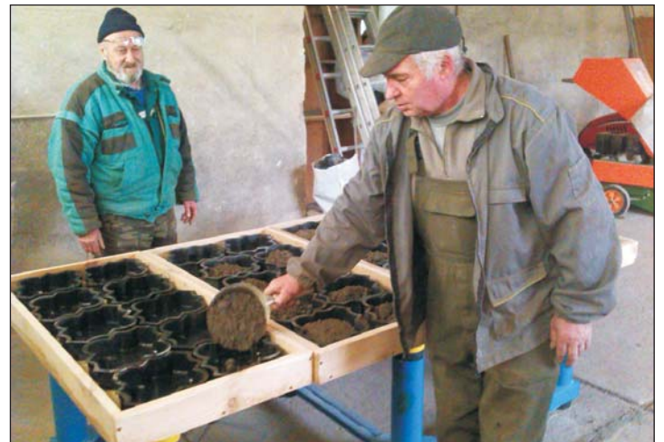
Cseh Németh János és Légler Imre készítik elő a betonformákat.
