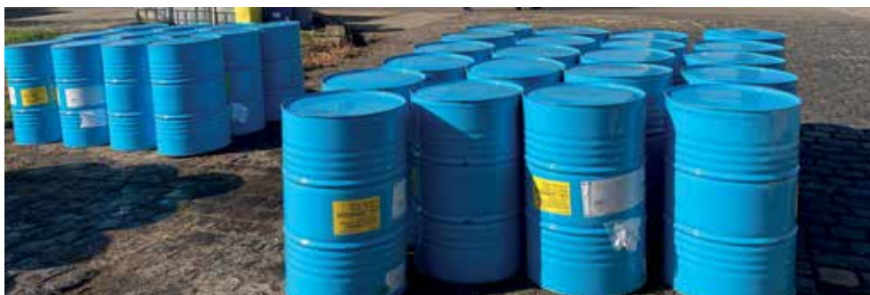
Oldószer-visszaforgatással egy sarzs előállításához tizenkét hordó technikai DKM szükséges, míg anélkül huszonegy
