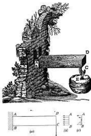
1. ábra. Galilei rajza a konzoltartóról
