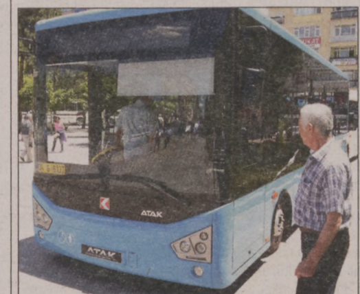
A Karsan A.S Atak típusú midibusza alacsonypadlós, Euro 6-os környezetvédelmi besorolású dízelmotorral szerelt, klimatizált. Teljes befogadóképessége 40 fő, az ülőhelyek száma 23.
