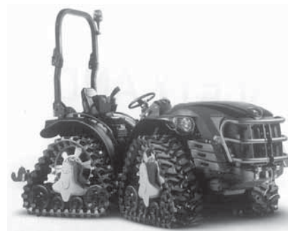
A „Mach 4” hernyótalp-futóműves traktor vezetőfülke nélküli változata, védőkerettel szerelve. Vontatmány nélkül a gép önsúlyának 60%-a nehezedik az első futóműre.
