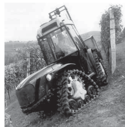
Az Antonio Carraro olasz gépgyár „Mach 4” tip. kistraktora zárt, klimatizált vezetőfülkével szerelve, szőlőmunkában tolómenetben. A képen jól szemügyre vehető a speciális gumihernyótalpas futómű a meghajtókerékkel és a feszítő-futógörgőkkel.
