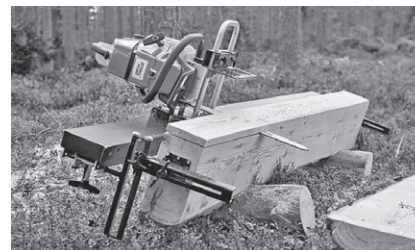
A tömérdek kiállítási látnivaló egyike volt a veszpremi LOGOSOL Kft. motorfűrészrel kombinált deszkametsző adaptere, (A kép cég-fotó.)
