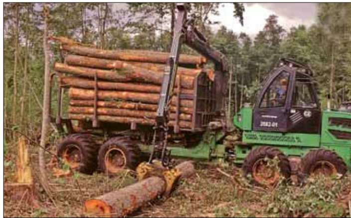
A belorusz gyártmányú Amkodor forwarderén jól megfigyelhető a vezetőfülke kialakítása, a hátsó ablak jó rálátást lehetővé tevő íveltsége
