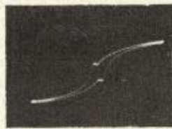
11. ábra. A jobboldali mérőtekercsbe helyezett magasabb telítésű permalloy B és a baloldali tekercsbe tett magasabb permeabilitású permalloy C differenciagörbéje. A nagyobb kezdeti permeabilitásra az origo közelében lévő emelkedés irányából lehet következtetni.
