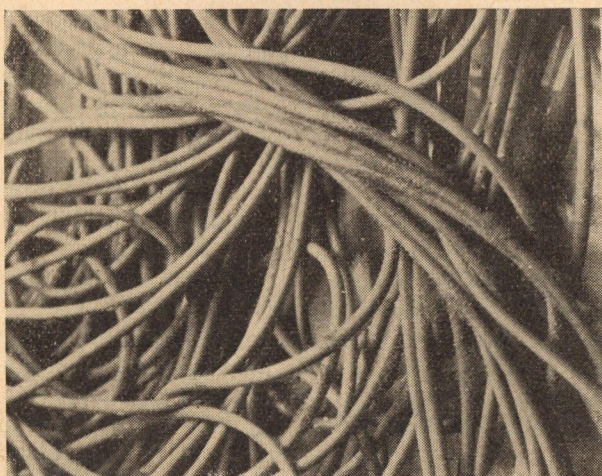
11. ábra. Latex-fonal, erős penészesedéssel. A felvételeket a Magyar Foto, Járai Rudolf készítette
