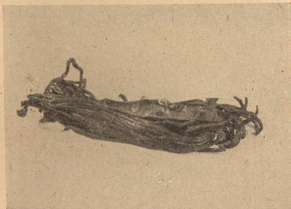
5. ábra. A IV. vonal páncélzat alatti ép kenderfonal és papír rétege
