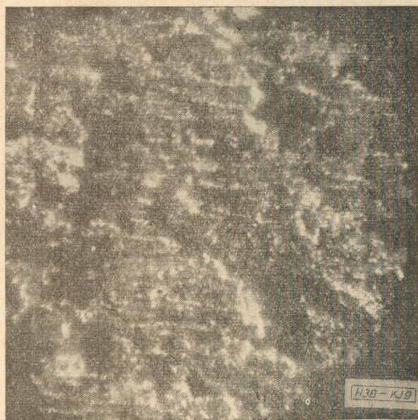
9. ábra. 8. ábra szerinti elrendezéssel homokolt alumínium-fólia (99,99 %) felületének mikroszkópikus képe (oldalvilágítással). Nagyítás: 280 ×
