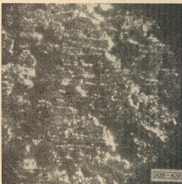
4. ábra. Vegyi maratás útján feldurvított alumíniumfólia (99,99%) felületének mikroszkópikus képe (felülvilágítással) Nagyítás: 150 ×
