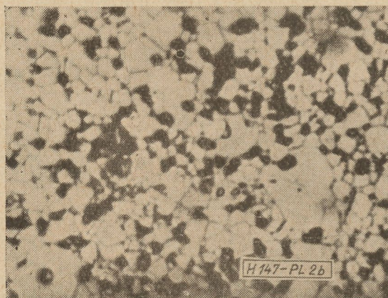
2b ábra. Előégetés 5 órán át, 900 C°-on, őrlés 24 órán át, végső égetés 5 órán át, 1350 C°-on
