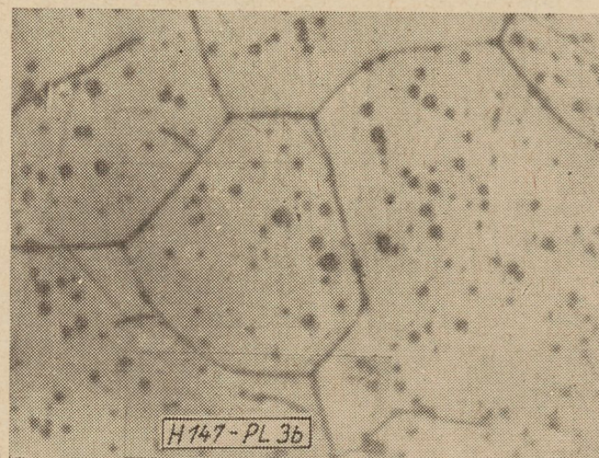
3b ábra. Végső égetés 10 órán át, 1350 C°-on
