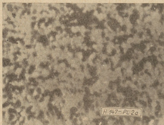
2a ábra. Előégetés 5 órán át, 800 C°-on, őrlés 24 órán át végső égetés 5 órán át, 1350 C°-on
