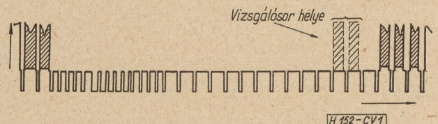
1. ábra. A vizsgáló sor helye a képváltójelben. OIRT ajánlás
