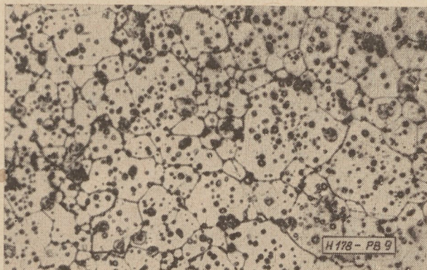
9. ábra. N11 típusú ferrit. Polygonális ferrit kristallitok. 1300° C, 2 óra hűtési idő. Az egyes kristallitokon belül maradási idomok. Kng fényesítés. Forró 1 : 1 HCl. Kisfilm. Nagyítás 320 ×
