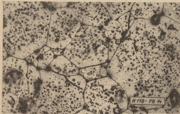
14. ábra. N11 típusú ferrit 2% CuO adagolással. A krisztallitokon belül maratósi idomok. Kng fényesítés, Forró 1 : 1 HCl. Kisfilm. Nagyítás 320 \times
