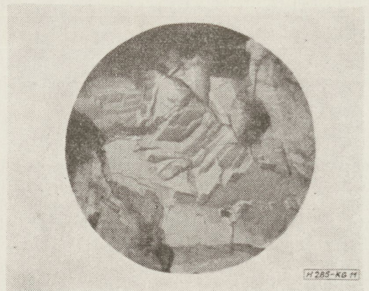
11. ábra. A feldurvított alumíniumanóda felületének elektronmikroszkopos képe ( 16000 \times )
