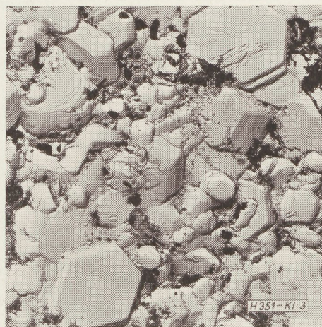
3. ábra. Hexagonális báriumferrit krisztallitok. (Az elektronmikroszkópos felvétel báriumferrit mágnes felületéről készült.)
