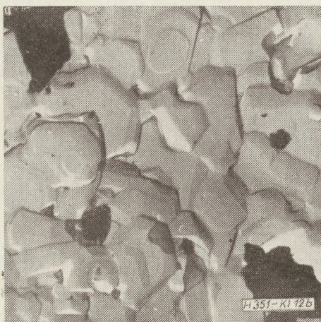
12b ábra Ugyanaz mint a 12a ábrán, a sajtolásnál alkalmazott külső mágnes tér irányára merőleges töretfelülettel
