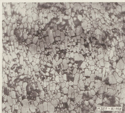
11a ábra. A 10. ábrán feltüntetett báriumferrit mágnesre azonos összetételű anizotróp mágnesanyagról készült maratott csiszolat. A csiszolat síkja párhuzamos a sajtolásnál létesített mágneses erő tér irányával
