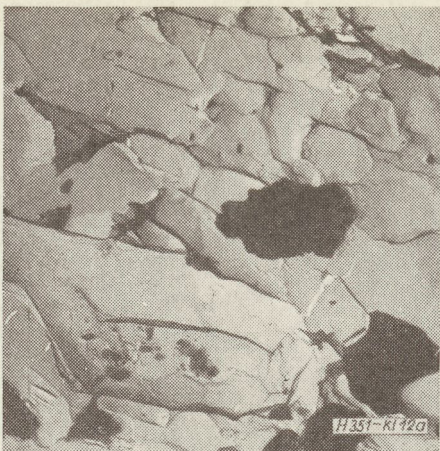
12a ábra. A 11a és a 11b ábrán feltüntetett anizotróp mágnesanyag külső mágnes tér irányával párhuzamos töretfelülete
