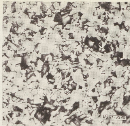
10. ábra. Izotróp báriumferrit mágnes mélymaratott csiszolata
