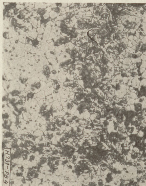
4. ábra. Levegőatmoszférában lehűtött U mag keresztmetszeti csiszolata. Nagyítás 250\times . Maratás 10\% HF
