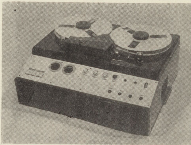
2. ábra. SHR-16 jelentéstároló lejátszó egysége
