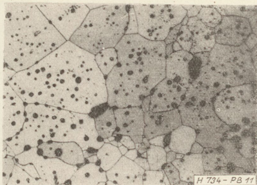
11. ábra. 1000° C-on előízzított ferritgyűrű szövetszerkezete. Maratás: 10% HF. Nagyítás: 250-szeres
