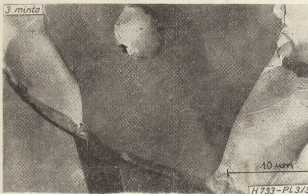
3. ábra. Az 1., 3., 4. és 5. sz. ferritminták elektronmikroszkópos töret felvételei
