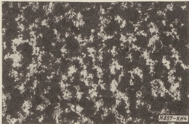
4. ábra. 1 jelzésű elektrolitkondenzátor-sorozat záróréteg-elektrolit határfelületéről készített fénymikroszkópos felvétel 10 000 órás elektromos és hőterhelés után (90×)
