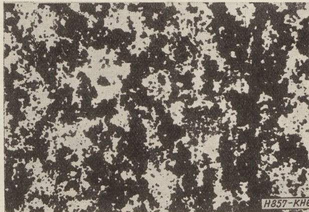
6. ábra. 18 jelzésű elektrolitkondenzátor-sorozat záróréteg-elektrolit határfelületéről készített fénymikroszkópos felvétel 10 000 órás elektromos és hőterhelés után (90×)
