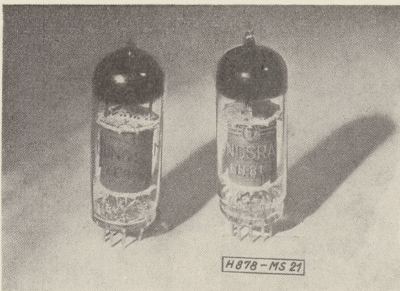
21. ábra. Az EH81 és megbízható változata, az E81H
