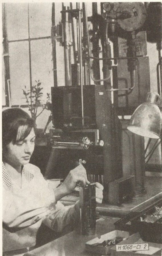
2. ábra. Egysugaras elektronágyú alkatrészeseinek berakása a szerelősablonba, háttérben a pneumatikus üvegezőgép
