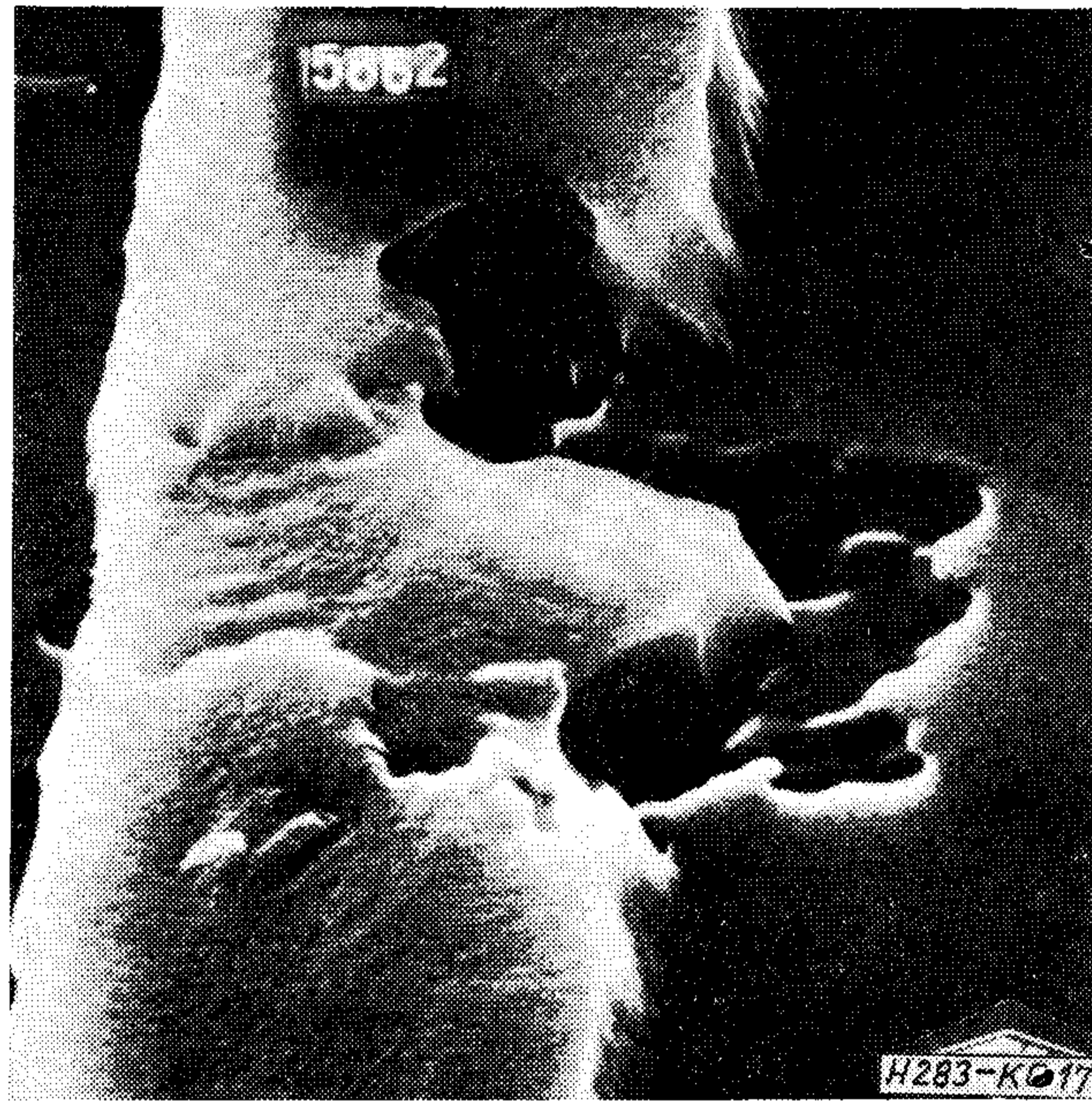
17. ábra. A látható keresztmetszet-csökkenés a fémezésben a helyi áramsűrűség-növekedéshez — a migráció, szakadáshoz fog vezetni (PEM 6000×)
