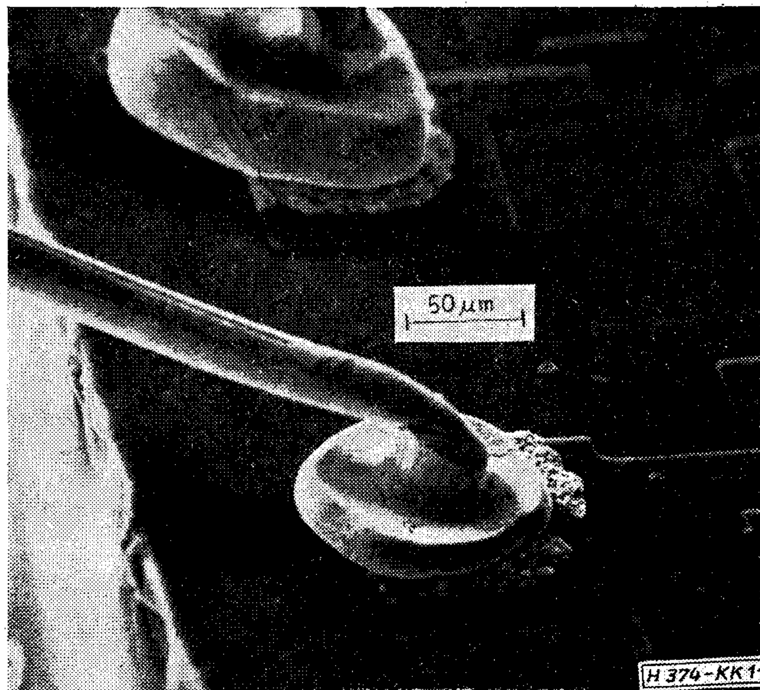
11. ábra. Erős fekete pestis SEM (pásztázó elektronmikroszkópos) felvétele két túllapított, repedt termokompressziós gömbkötés körül. Az Au_5Al_2 + Au_2Al intermetallikus fázisok habosan laza szerkezete az élvilágítású felvételen jól megfigyelhető (Stefániay Vilmos felvétele)
