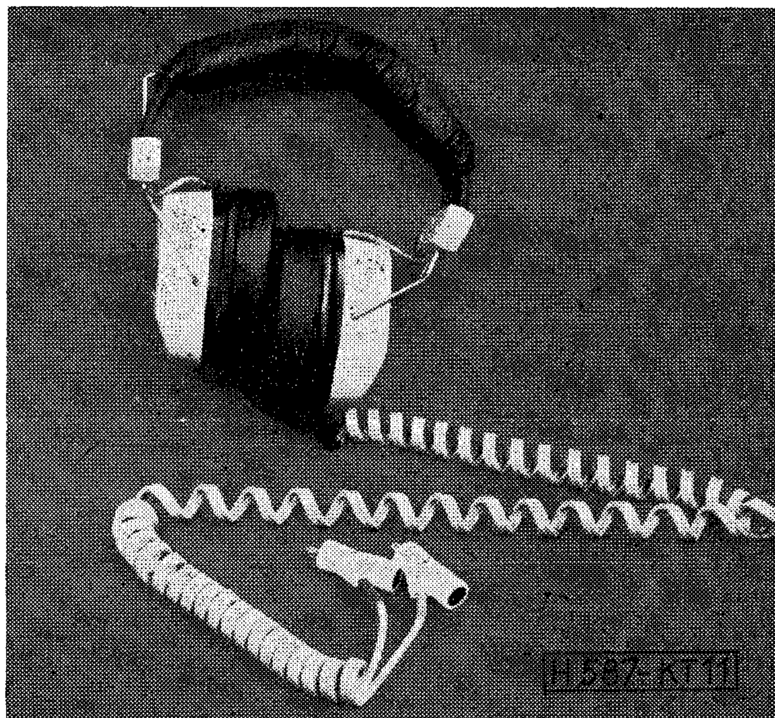
11. ábra. Fejhallgató rugózó mikrofon-vezetékkel
