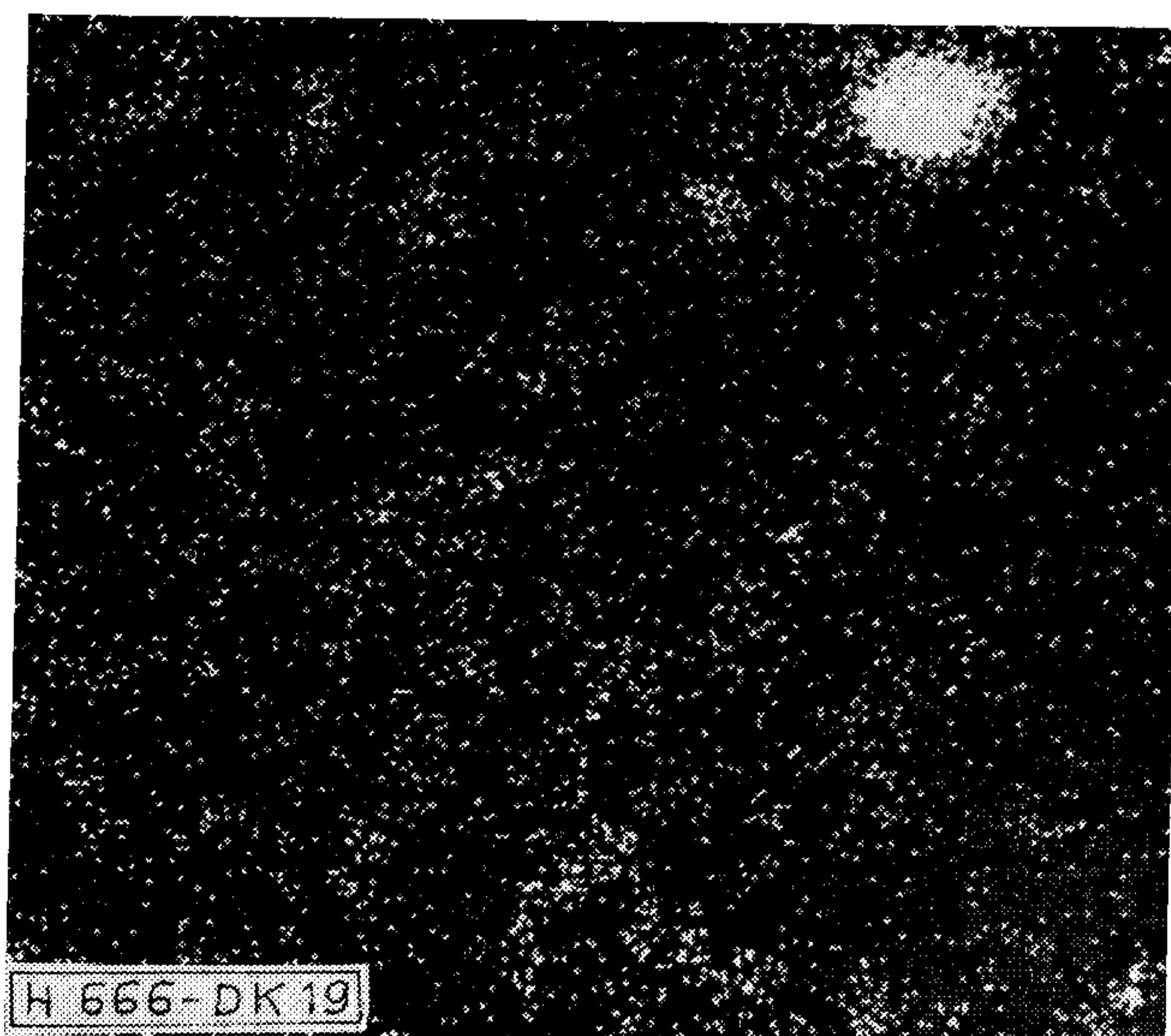
19. ábra. Aranyozott minták ezüstön 21 nap 15 cm 3 /m 3 H 2 S 75% rel. nedv. ClKα-kép (klór), gyorsítófesz. 20 kV
