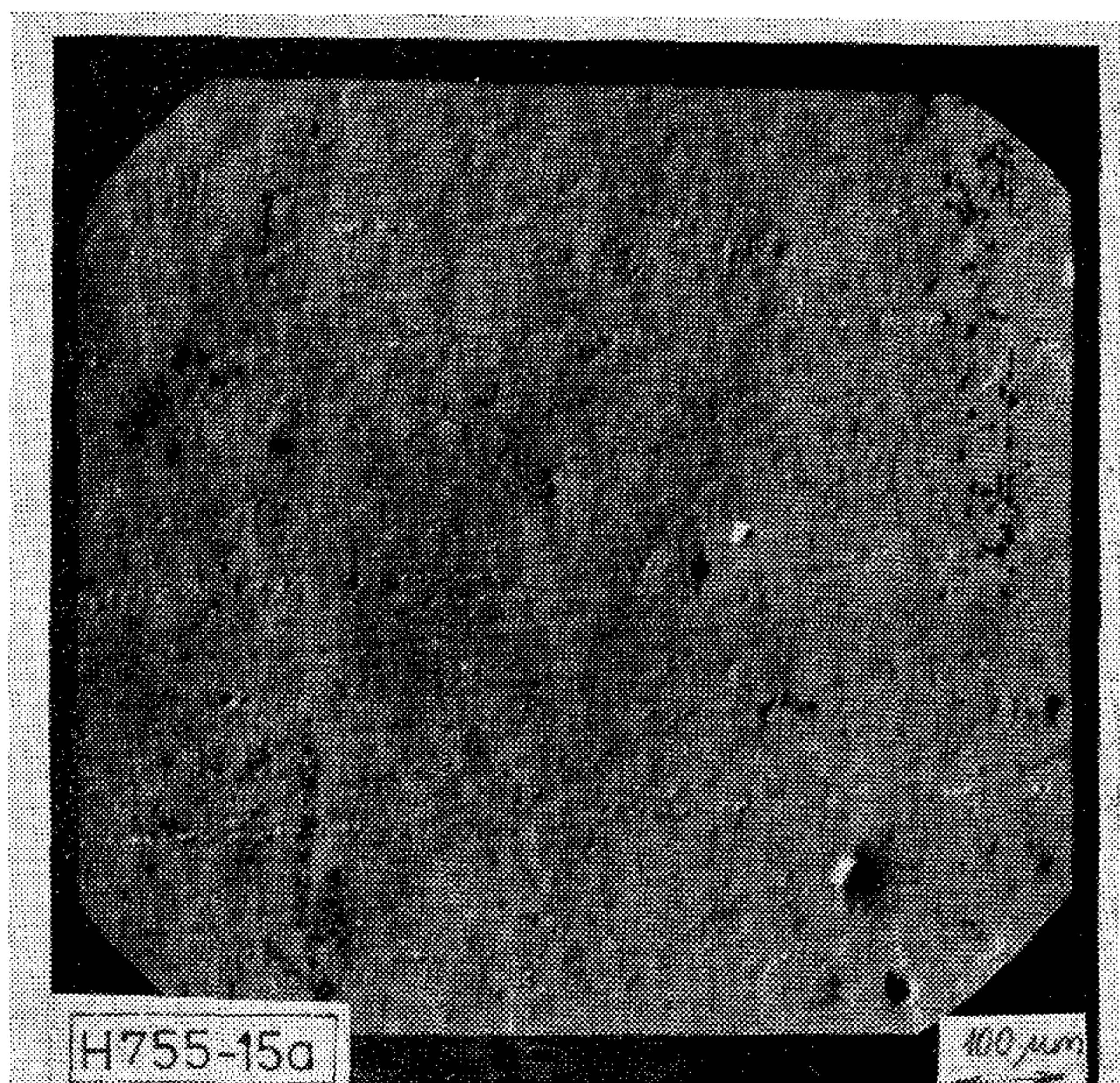
a) 100 menet nyoma, (SEI, 25 kV), 100\times nagyítás;
