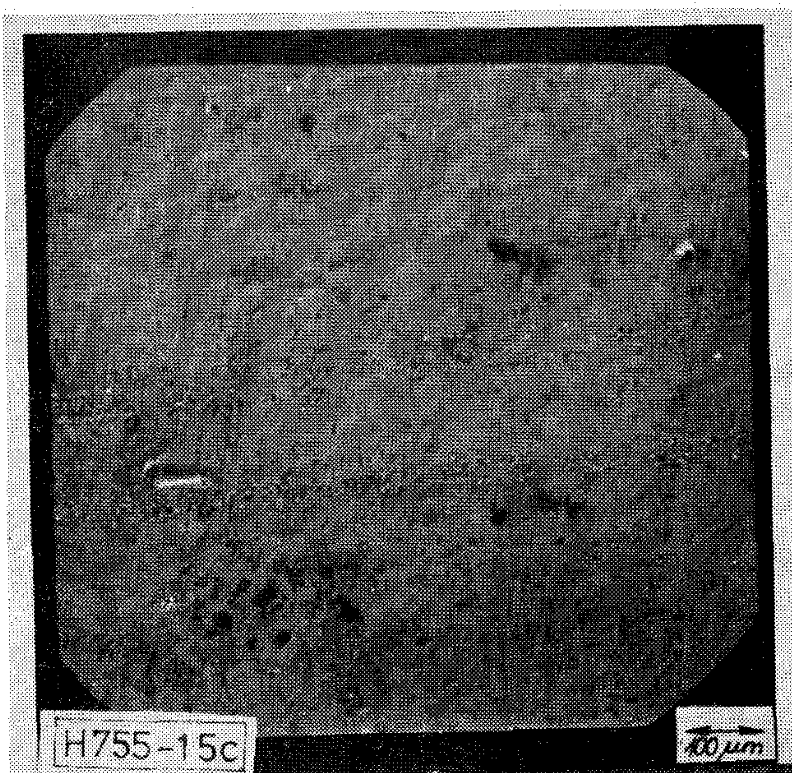
c) 200 koptatási menet nyoma, (SEI, 25 kV), 100\times nagyítás;
