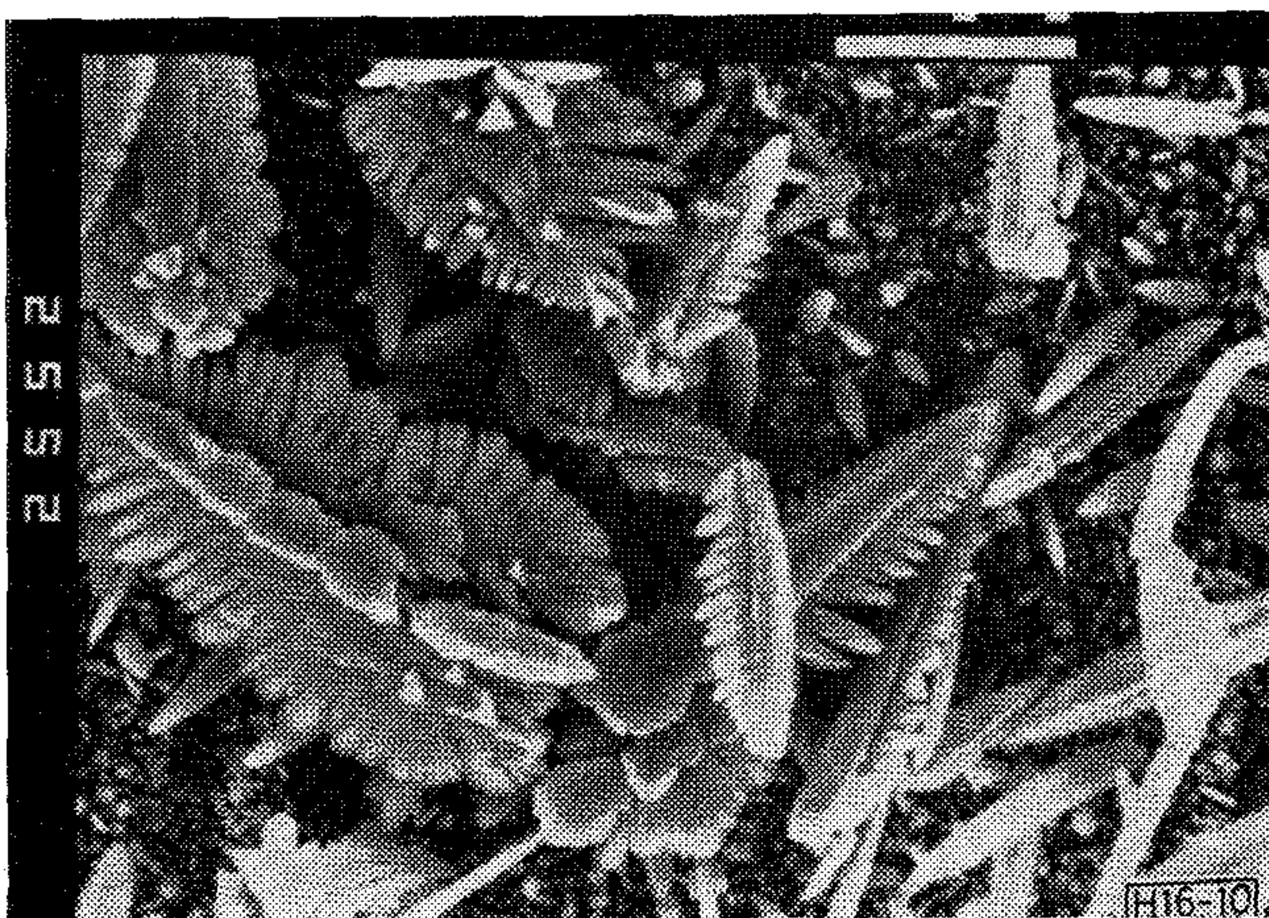
10. ábra. Dendrites szerkezet kialakulása 0,45 g/l Co-tartalom esetében 25 °C-on. 4 perces leválasztáskor 450 A/m 2 áramsűrűség mellett. SEM 2000×
