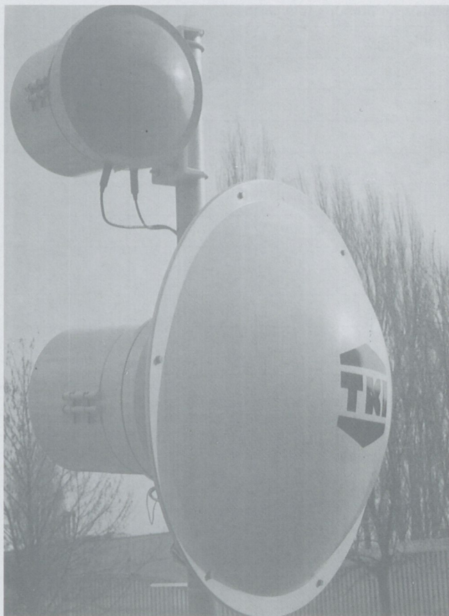
1. ábra. SAMI-15 RF konténerek: parabola, ill. mikrosztrip antennával
