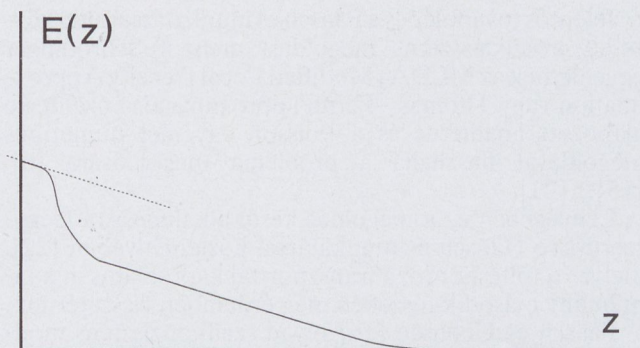
14. ábra. A térerősség helyfüggése erős inverzióban a kvantummechanikai hatások figyelembevételével
