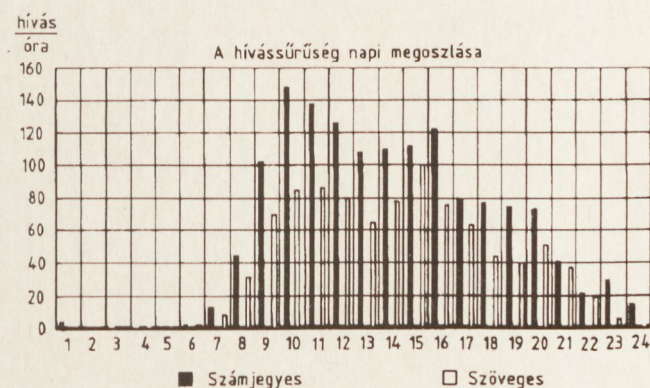
1. ábra. A személyhívó rendszer hívásszámainak napi eloszlása
