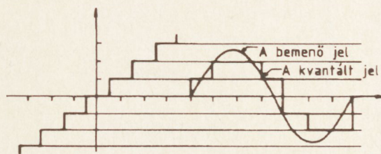
5. ábra. A kvantálók átviteli karakterisztikájának lépcsőfüggvénye
