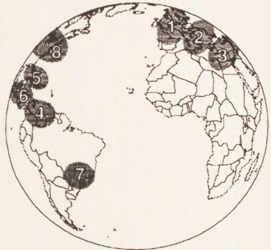
3. ábra. Többnyalábos nagykapacitású műhold megvilágított területei
