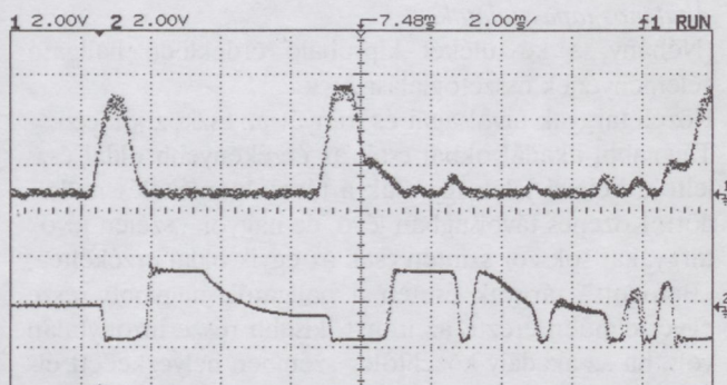
17. ábra. Másik példa valós visszaverődési képre. (1. csatorna: az ultrahang vevő felerősített és demodulált jele; 2. csatorna: a feldolgozott jel.)
