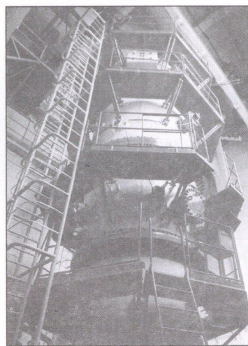
5. ábra Az 1968–70-ben épült 5 MV-os nyomás alatti Van de Graaff gyorsító látképe
