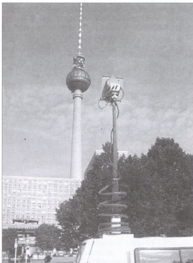
5. ábra Digitális közvetítőkocsi antennaegysége (FlexRepo)
