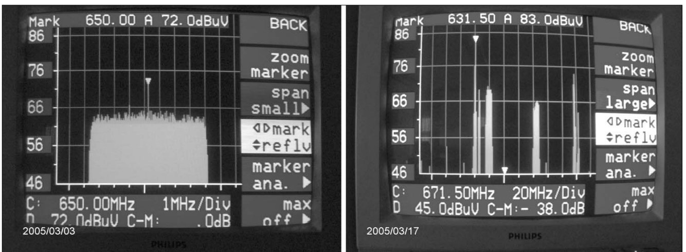
15. ábra Spektrumanalízis az MSK 33 mérővevővel.
