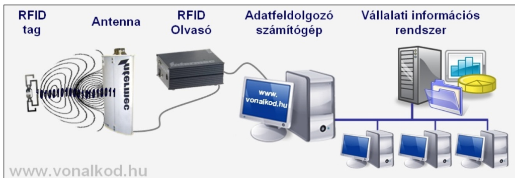
1. ábra Az RFID rendszer felépítése
