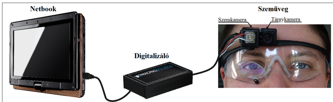
4. ábra Az IKTIVision rendszer felépítése
