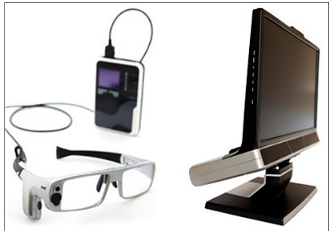
2. ábra Mobil és rögzített optikai tekintetkövető eszközök
