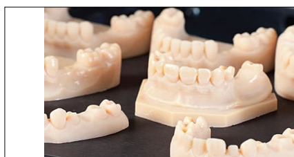
6. ábra 3D nyomtatott Stone-modellek (Forrás: www.javelin-tech.com )
