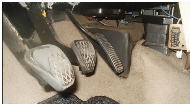
2. ábra OBD csatlakozó helye egy Rover 25-ös modellben
