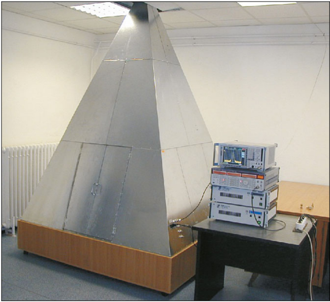
6. ábra Immunitás vizsgálatokra szolgáló GTEM cella
